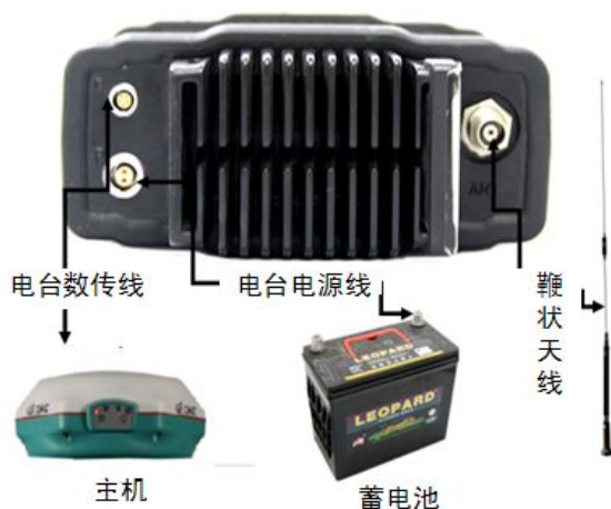
图 2-4 电台连接图
