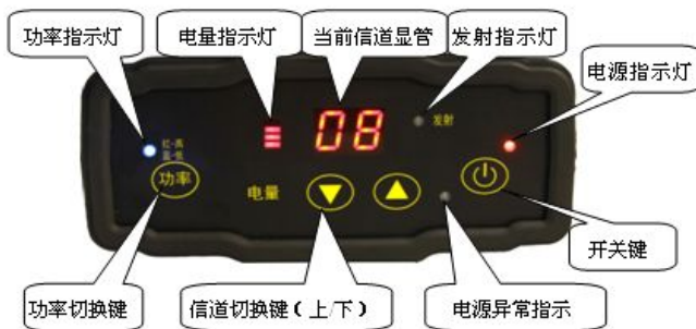
图 2-5 电台面板及各功能示意图
