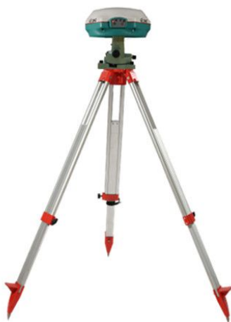
图 3-1 静态测量仪器安置
